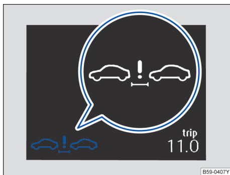
图 109 组合仪表显示屏中：车距预警显示
