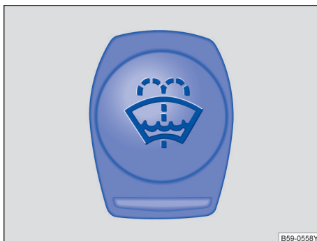
图 154 发动机舱内：车窗清洗液容器盖
