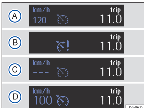
图 102 组合仪表显示屏：定速巡航系统状态显示
