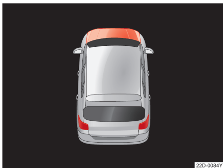
图 153 在组合仪表的显示屏上：发动机舱盖打开或未正确关闭
