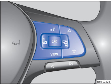
图 18 多功能方向盘右侧：用于操作信息显示器中菜单的按钮
