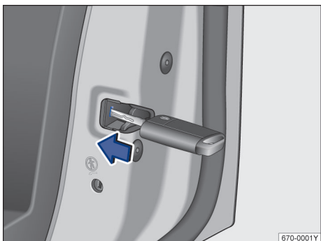
图 53 车门应急上锁装置及汽车钥匙
